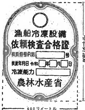
冷凍設備検査合格証
